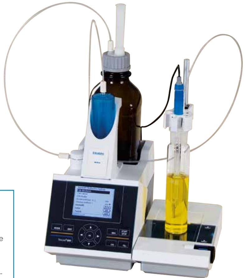
Abbildung zeigt die Titrationsanwendung „Chemischer Sauerstoffbedarf“, CSB
